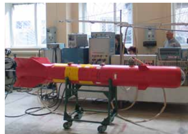
Телеметрическое изделие КАБ-500Кр на стенде
