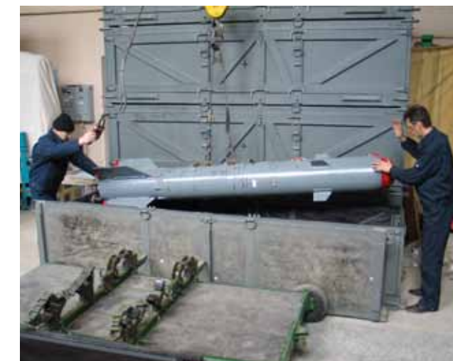
Укладка КАБ-500Кр в контейнер
