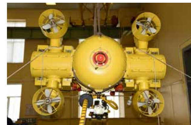
Подготовка СПА к испытанию в гидробассейне
