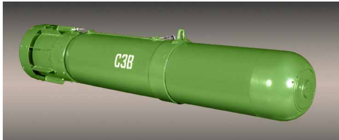
Противолодочная корректируемая авиабомба «Загон»
